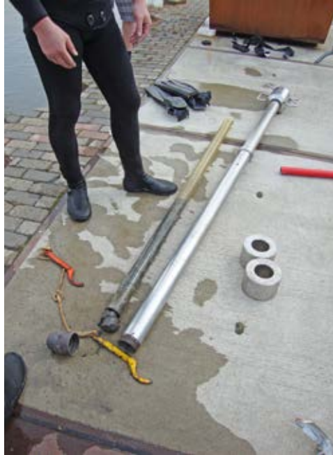
Afb. 4.6 De handboor na gebruik. Links is de plastic buis te zien, gevuld met sediment, rechts de slagguits waar de plastic buis in is geplaatst. De handvatten rechtsboven zitten aan een gewicht vast waarmee de buis de grond in kan worden geslagen.
