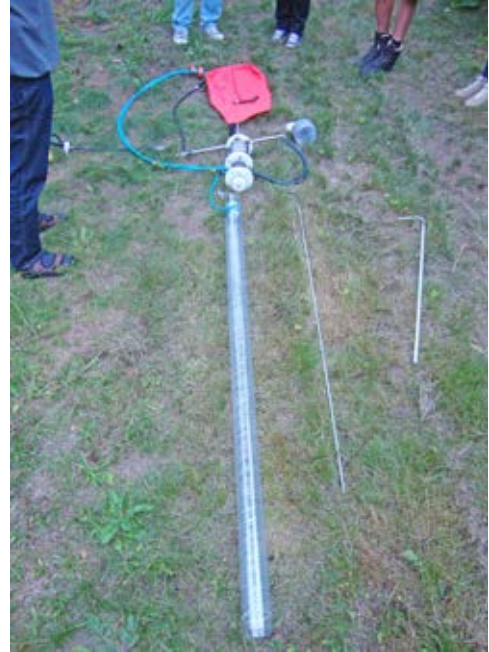
Afb. 4.7 De Akut Vibrocore, onder aan de plastic buis die de grond in wordt gedreven, daarboven het boorsysteem en in rood de hefballon om de boor weer uit de grond te krijgen.
